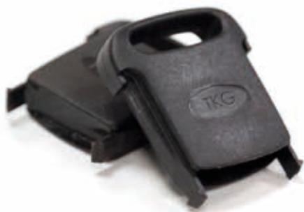
Per abilitare la clonazione dei transponder **Texas® 80 bit**, utilizzati da diversi modelli d'auto Toyota®, con il **chip in ceramica CKG** e con la **testa elettronica TKG** basta attivare l'aggiornamento software **TKG. Kit** semplicemente inserendo nel proprio dispositivo la testa elettronica TKG, presente all'interno del kit. Dopo l'attivazione, la testa elettronica TKG potrà essere normalmente riutilizzata per effettuare una clonazione completa.
