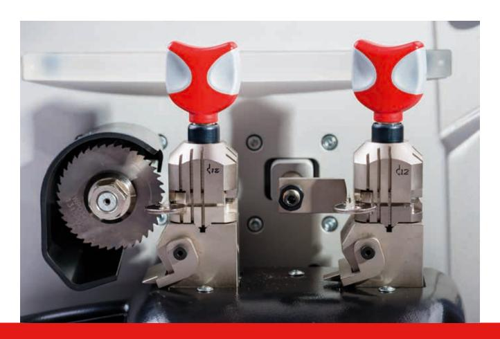
Ninja是第一台也是唯一的一台结实且高度精密的电子钥匙复制机,它适用于在扁形钥匙的一侧或双侧刻制和 复制代码或解码。它的机身尺寸和简洁的设计使它可以适应各种工作环境, 从很复杂和非常专业化的环境到那些很简单的环境,以及那些需要优化空间的环境。它整合了最简单的和对专业锁匠而言最先进的性能为一体。这款机器由可移动的控制台操纵,该控制台轻便,其设计适合放置在机器上方,在工作台上或挂在墙上。Ninja可以设置在单机模式,它 不需要与控制台或电脑连接,可以以非常的速度执行最基本的复制操作,同时保证最精确和最可靠的质量。
