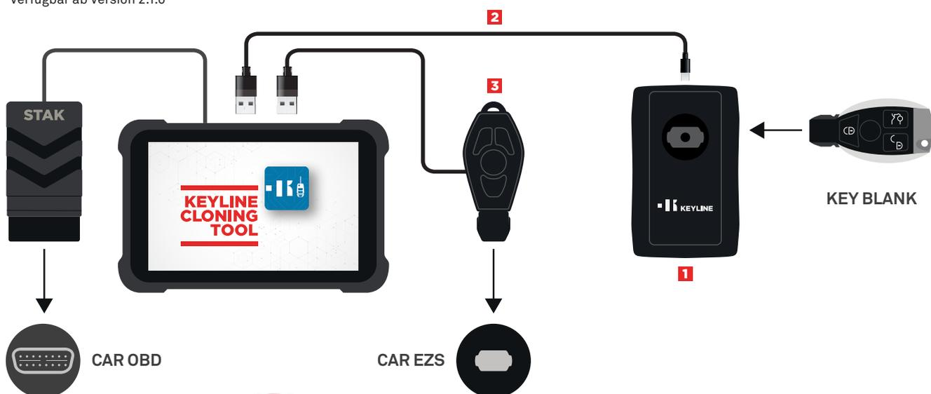
Der **IR-Emulator**, der in das Zündschloss des Fahrzeugs eingesetzt wird, simuliert die Original-Fernbedienung, um Daten aus dem Steuergerät zu lesen.
