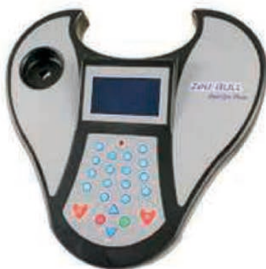
Zed-Bull (Cat Chiavi), lettore/clonatore di transponder, elaboratore di file .bin per la produzione di nuovi transponder su codici originali.
