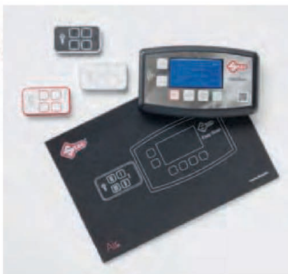
Easy Scan, duplicatore che guida l'operatore nella duplicazione dei radiocomandi originali (Silca).
