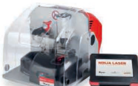
Ninja Laser di Keyline, duplicatrice elettronica che combina due diverse tecnologie: con fresa circolare a velocità variabile e con fresino a candela, per tagliare con la massima efficienza chiavi piatte porta e auto, laser e Tibbe a codice, a decodifica o con l'inserimento della cifratura.
