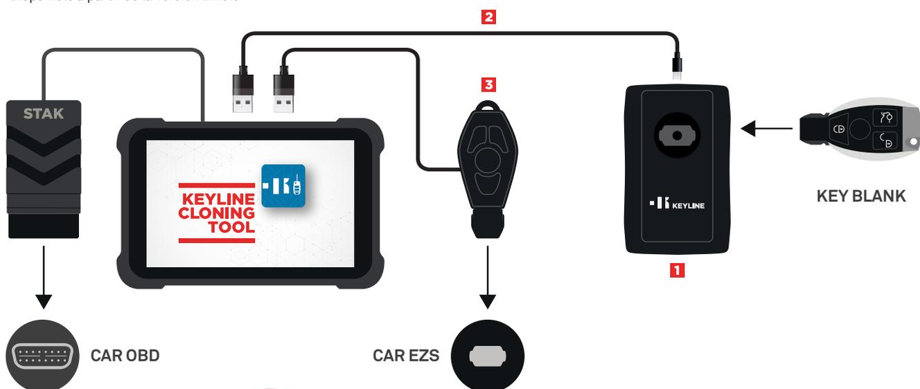
L'émulateur IR inséré dans le bloc d'allumage de la voiture simule la télécommande d'origine pour lire les données de la centrale.
