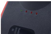
绿色指示灯表示884 Decryptor Mini 与设备连接并且连接电源。三个红色指示灯表示复制程序的进行状态。当红色LED灯闪烁时，说明机器在工作中，如果常亮的话则说明机器完成了某个阶段的工作。如果所有的指示灯都常亮的话，说明复制的流程完成。有关其他信息，建议参考机器使用手册。
